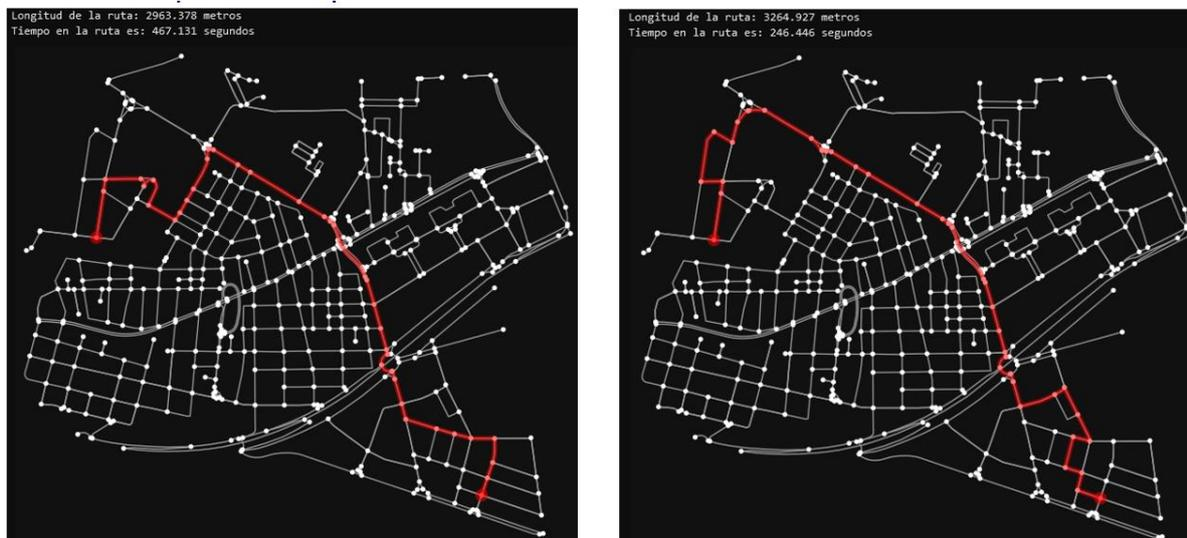
Figura 35. Longitud y duración de trayecto con algoritmo ACO
