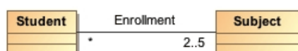
Figura 14. Ejemplo del tipo de relación 'matrícula' ( Enrollment ) donde se indica el número mínimo y máximo de instancias que pueden intervenir en la relación
