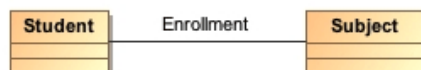
Figura 11. Ejemplo del tipo de relación binaria 'matrícula' ( Enrollment ) entre los tipos de entidad 'estudiante' ( Student ) y 'asignatura' ( Subject )
