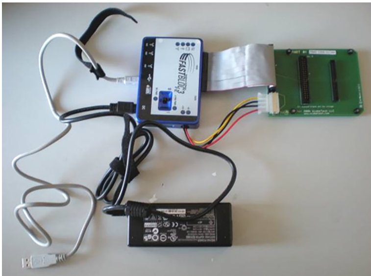
Figura 11. Write blocker (FastBloc 3, de Guidance Software) con el cable USB de conexión al ordenador de análisis
