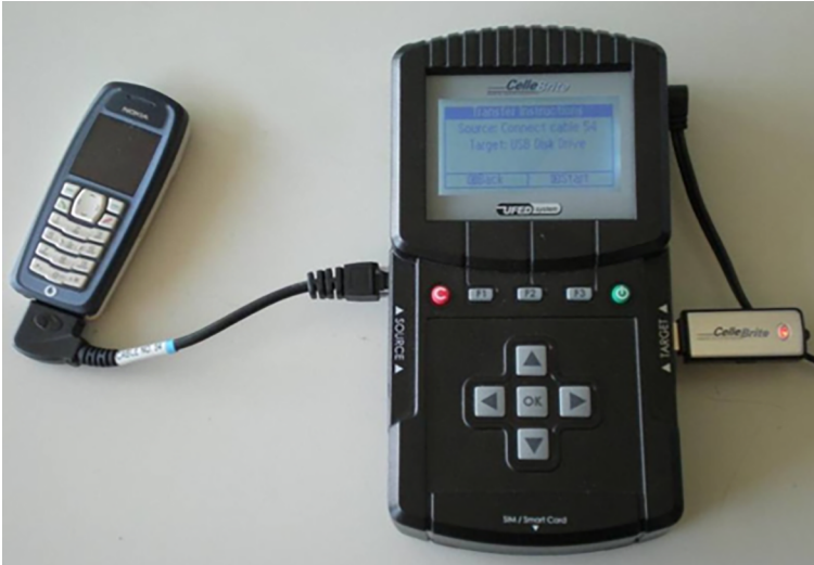
Figura 4. Abocament d'informació d'un mòbil a un dispositiu USB (de Cellebrite)
