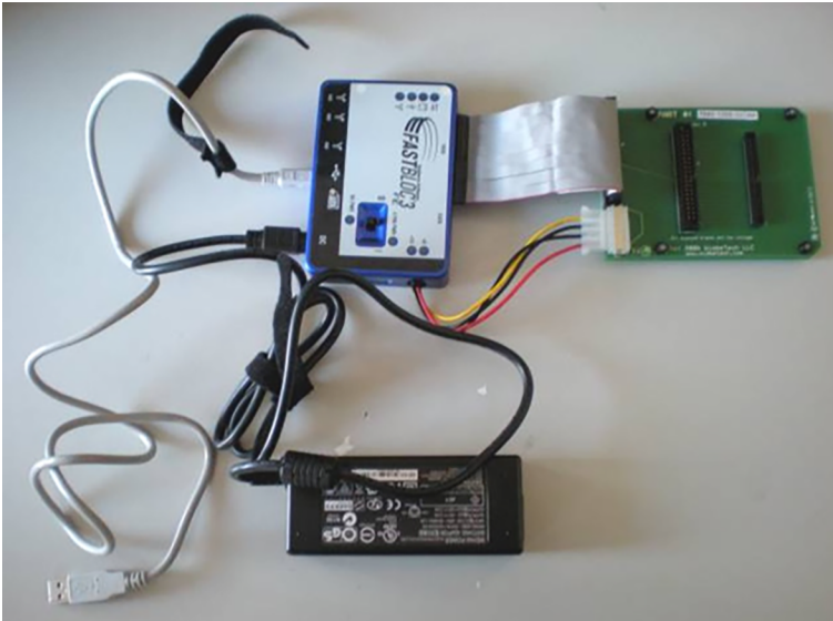
Figura 11. Write blocker (FastBloc 3, de Guidance Software) amb el cable USB de connexió a l'ordinador d'anàlisi
