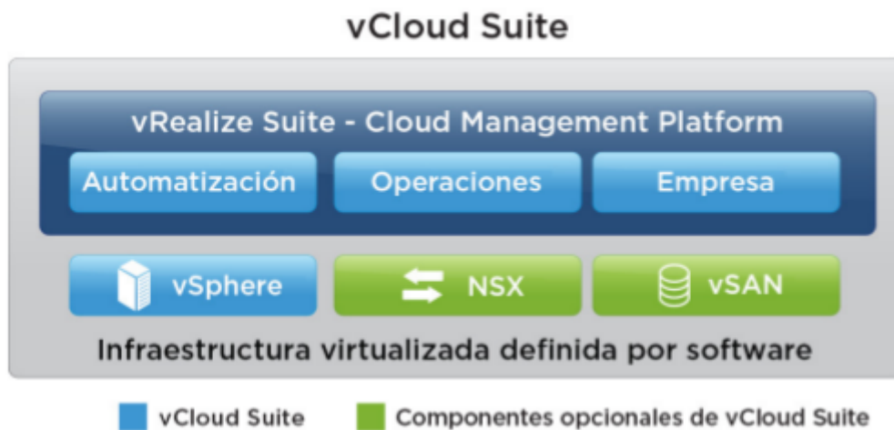
Ilustración 2: Esquema vCloud Suite de VMware
