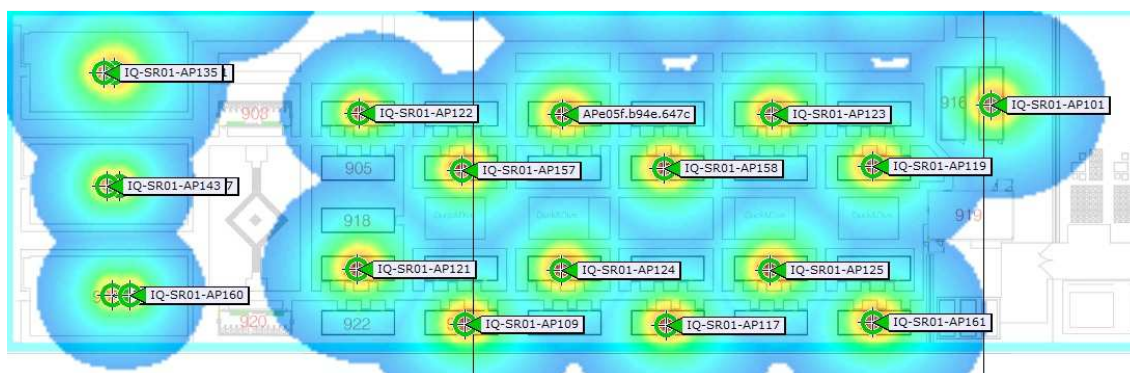
Figura 11. Cobertura Inalámbrica en Zigzag
