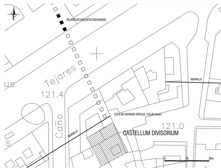
Fig. 15 Pilares de la arcuatio detectados arqueológicamente y reconstrucción de la entrada a Córdoba del Aqua Augusta (Pizarro, 2012: 97)
