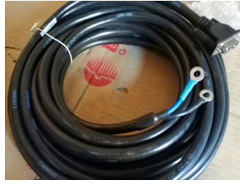
Figura 34. Cable de alimentación de RRU a convertidor CC/CA. [67]
