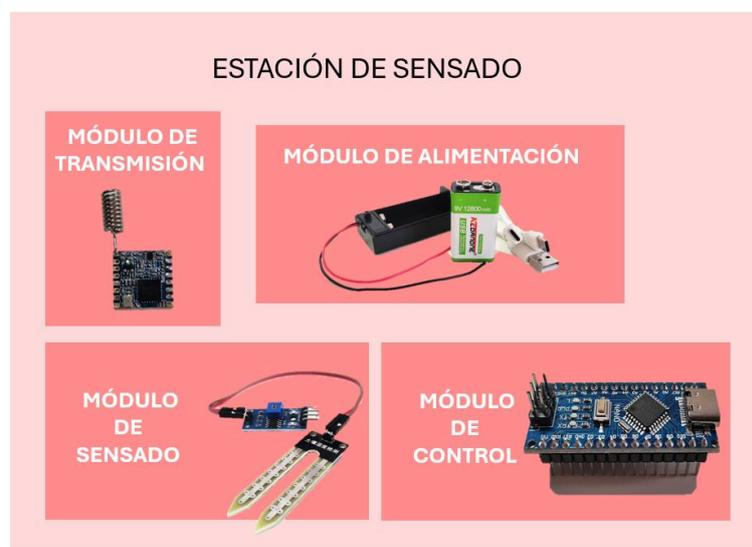
Figura 10. Esquema de una Estación de Sensado
