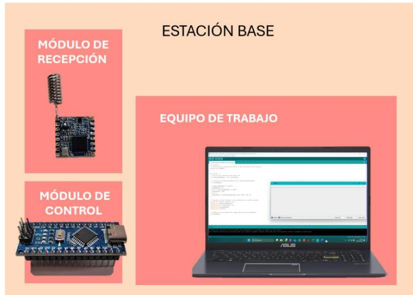
Figura 18. Esquema de la Estación base
