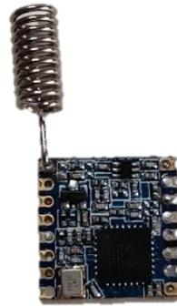
Figura 20. Modulo SX1276 de LoRa para Arduino
