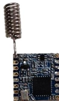
Figura 13. Modulo SX1276 de LoRa para Arduino
