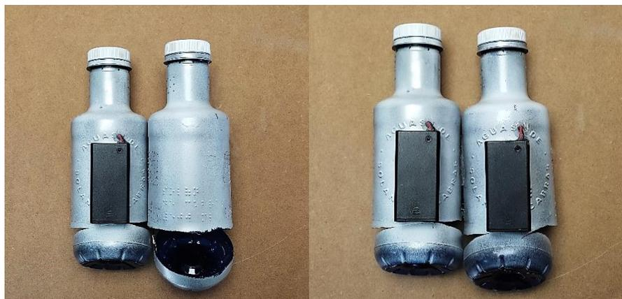
*Figura 35. Encapsulado complementado con las carcasas de las baterías*
