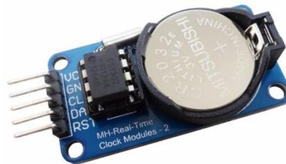
Figura 65. Módulo RTC
