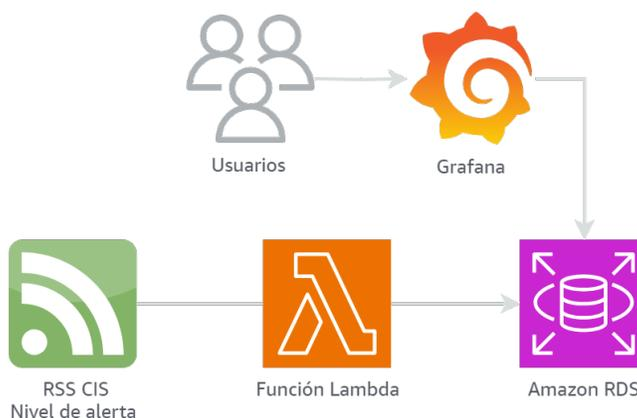
Figura 4.3: Arquitectura de la solución con las tecnologías empleadas a alto nivel
