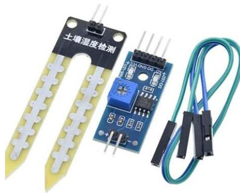
Figure 9. Sensor de humedad de suelo Hailege LM393
