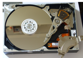
Interior d'un disc dur, on es mostra el braç lector/escriptor.
