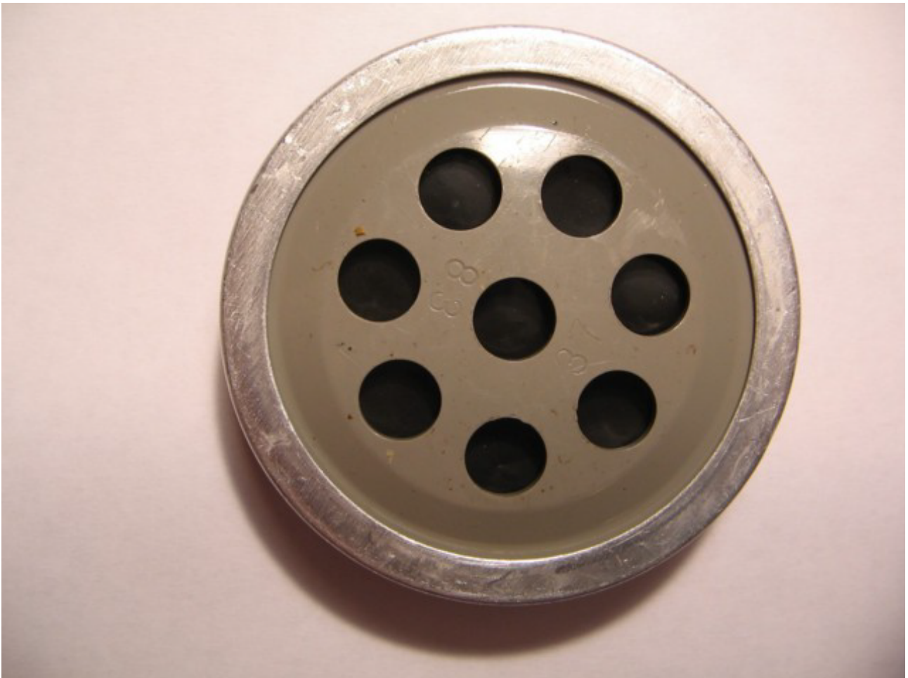
Ilustración 1: Típico micrófono de carbón extraído de teléfono de disco
