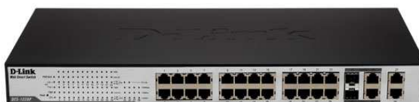
Fig. 3.21 Switch (D-Link DES-1228).
