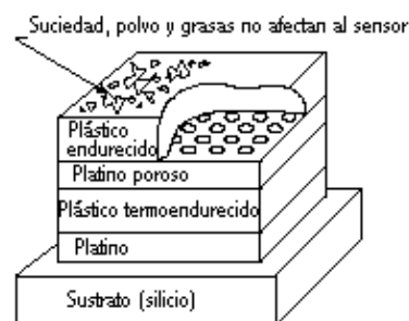
Figura 22: Principi del Sensor Humitat capacitiu.
