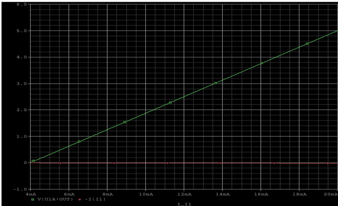
Figura 17: Simulación de la entrada analógica 4..20 mA
