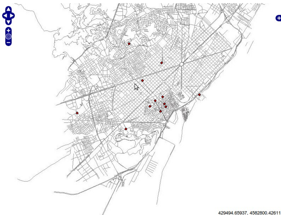
Figura 6-2. Mapa d'OpenLayers amb les capes de les taules ways i puntsturistics de la base de dades, proporcionades mitjançant MapServer (WMS) amb el EPSG:25831, que es pot comprovar amb les coordenades a peu de mapa de la posició senyalada pel cursor.
