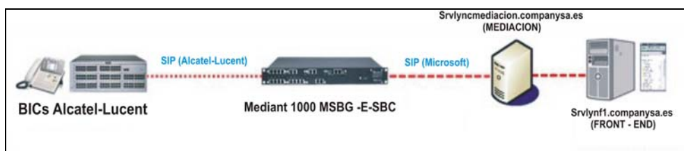
IMAGEN 12: Instalación Media Gateway 1000 MSBG E-SBC
