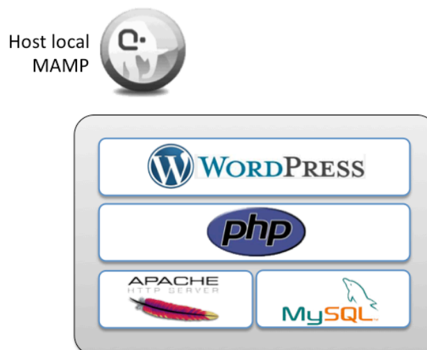
Figura 5: Elements instal·lats en el Host MAMP
