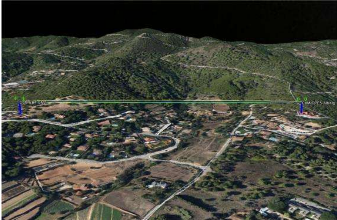
Imatge 47: Enllaç torre de comunicacions del cementiri - Alberg Torre Ametller
