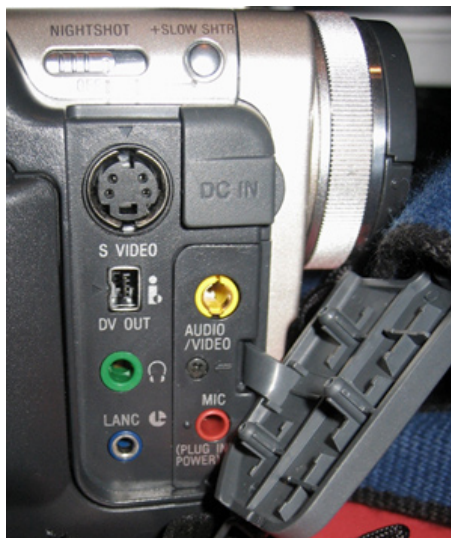
Panell de connexions d'una càmera de vídeo digital.
