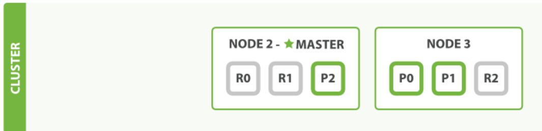
Figura 6 - Fallada de node 1
