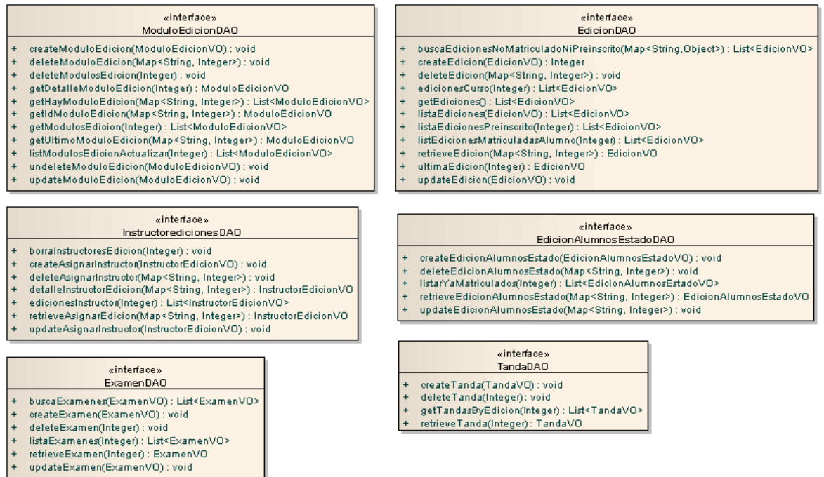
Ilustración 20 - Interfaces DAO del subsistema ediciones
