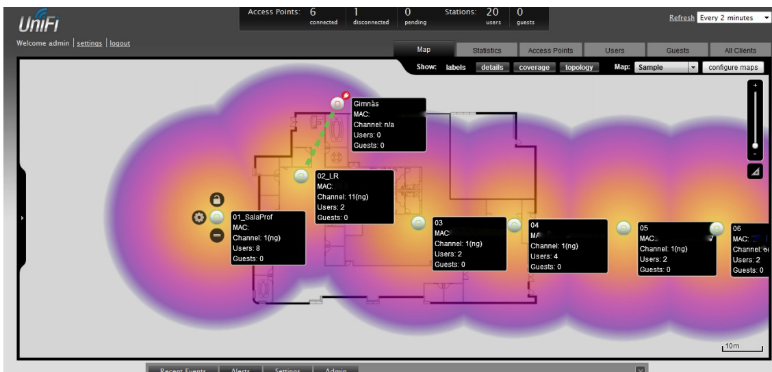
Ràdio de cobertura dels AP. En línia verda, connexió configurada com a repetidor
