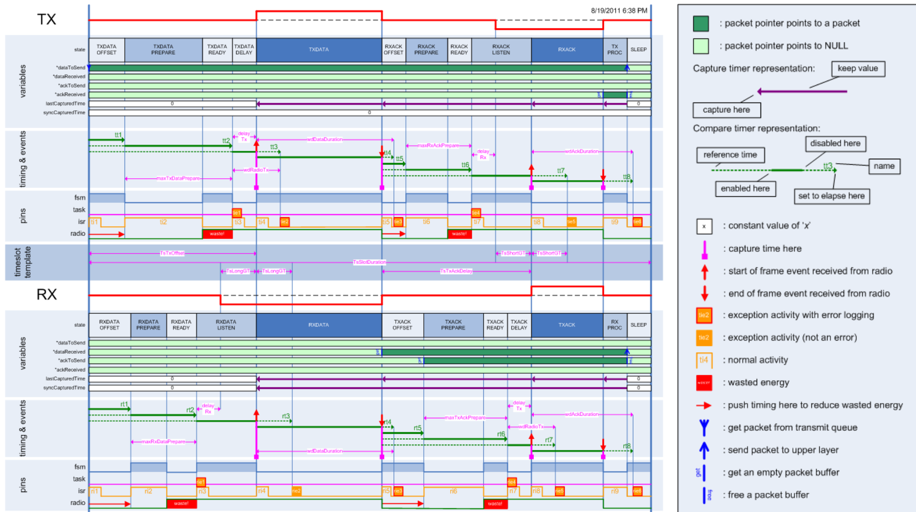
Ilustración 31: Máquina de Estados Finitos (FSM) en Transmisión (TX) y Recepción (RX) en un Timeslot
