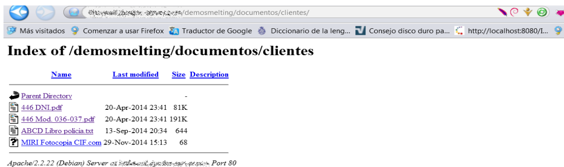
Figura 48: acceso indebido a un listado de directorios privado
