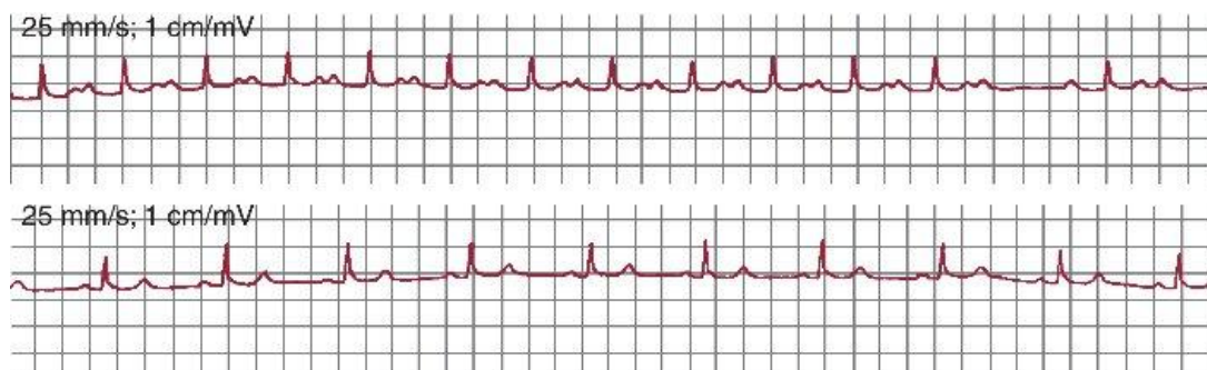
Ilustración 16: señal ECG con variaciones de la línea base [21].
