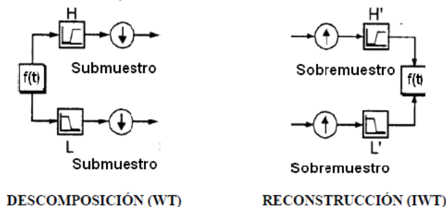
Ilustración 55: proceso de descomposición y reconstrucción de la señal f(t) mediante el análisis multiresolución.
