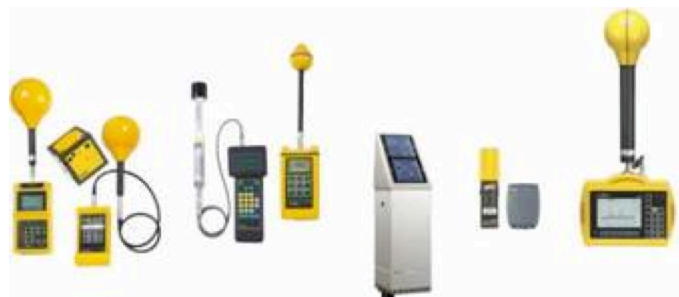
Figura 4- Diversos tipos de analizadores de campos E y H con sus sondas.
