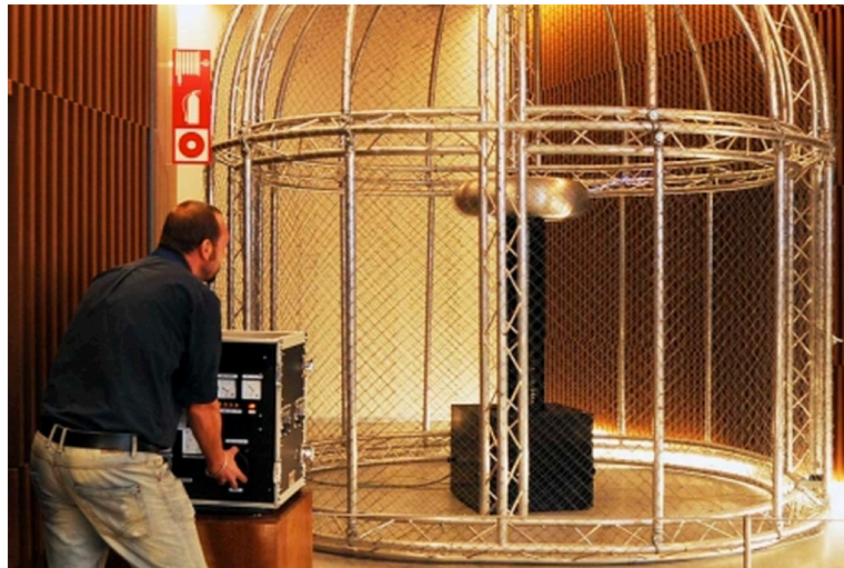
Figura 25- Jaula de Faraday con E=0 en interior.
