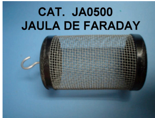
Figura 24- Jaula de Faraday hecho con malla de alambre.
