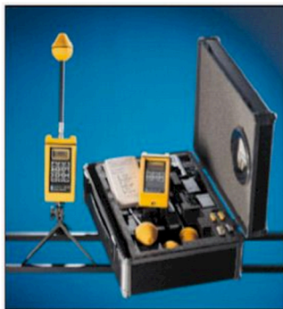
Figura 3-. Analizador de campos con sonda y analizador de espectro.
