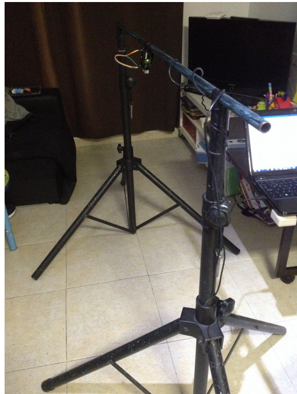
Il·lustració 8. Muntatge per l'assegurament de l'alçada del sensor
