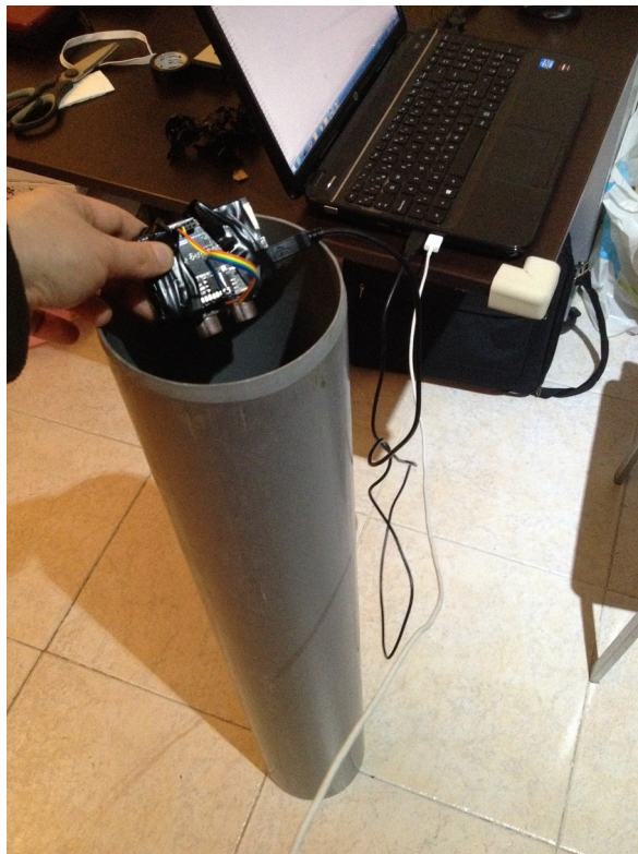
Il·lustració 25. Gir del sensor dins d'un tub de PVC
