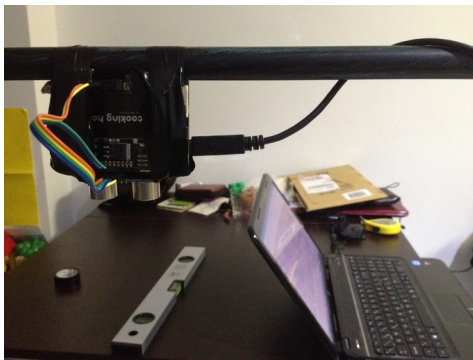
Il·lustració 7: Muntatge d'Arduino i sensor HC-SR04 a la barra de ferro
