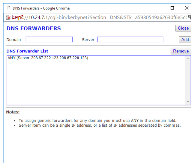
Ilustración 14: Configuración de los DNS forwarders
