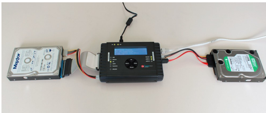
Figura: Clonadora de discos con sistema write-blocked. En este caso está realizando una copia fidedigna del contenido de un antiguo disco duro IDE en un nuevo disco duro SATA
