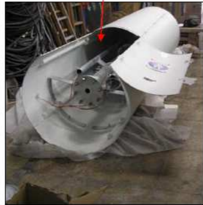
Figura 168. Torre con estructura cilíndrica y puertas para mantenimiento
