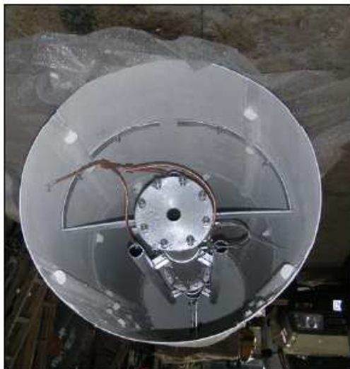
Figura 170. Antena trisector en mástil cilíndrico
