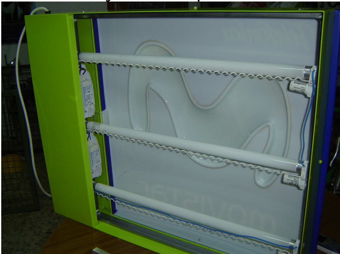
Figura 206. Interior de cartel luminoso real (sin adaptación)
