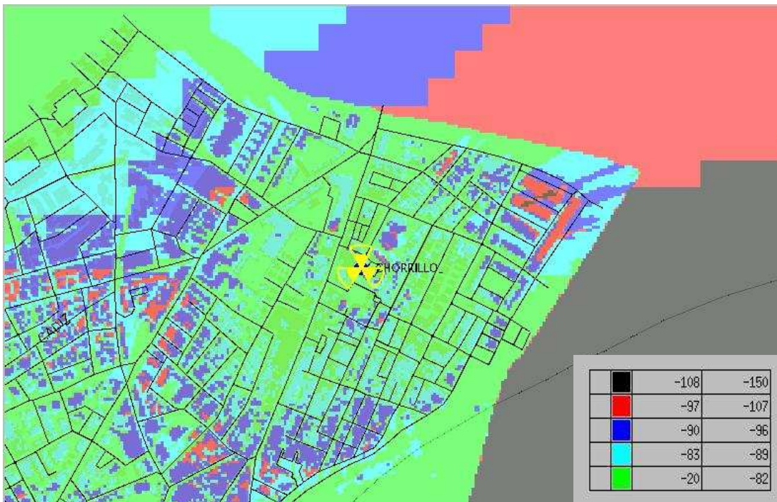
Figura 124. Cobertura. Nivel RSRP emplazamiento CHORRILLO. Fase 0.
