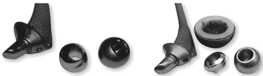
Prótesis extraída En las imágenes podrá apreciarse el desgaste del cono morse tomado al vástago y el desgaste de la cabeza metálica
