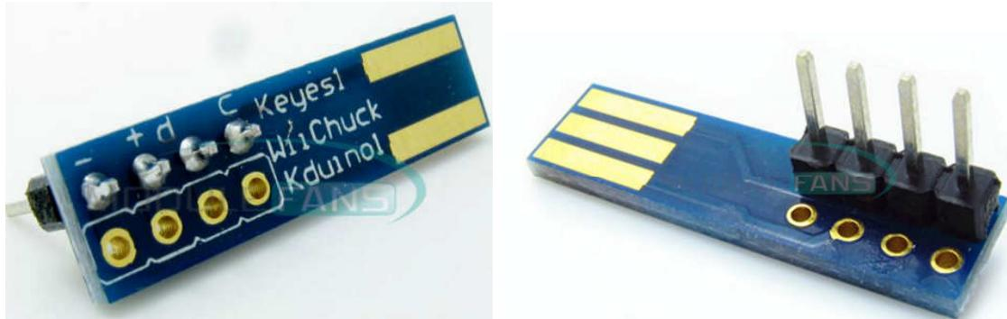
Este conector facilita la conexión o soldadura de cables a usar para conectar el Nunchuk con la placa de desarrollo.
