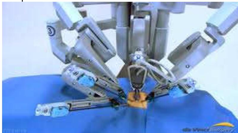
El dispositivo de control de estos brazos robot actualmente no son un nunchuk, sino dispositivos basados en joysticks y botones. El autor de este TFM piensa que el uso de sistemas de control que incluyan acelerómetros pueden añadir profundidad y precisión en el control de estos brazos.
