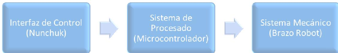
Esto se corresponde con una conexión física entre el Nunchuk y la placa de desarrollo y otra conexión entre la placa de desarrollo y el brazo mecánico.
