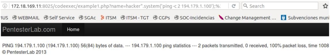
Figura 27: inyección de código "ping -c 2 194.179.1.100".
