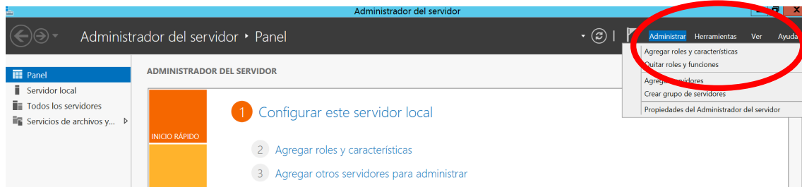
Ilustración 57 - Instalación servicio DNS (paso 1)
