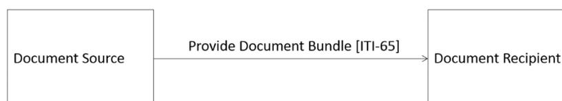
El módulo MHDSOURCE efectivamente lanza la transacción **ITI-65 ProvideDocumentBundle** contra el servidor. En el servidor, el módulo encargado de recibir este envío es el módulo MHDRecipient.
