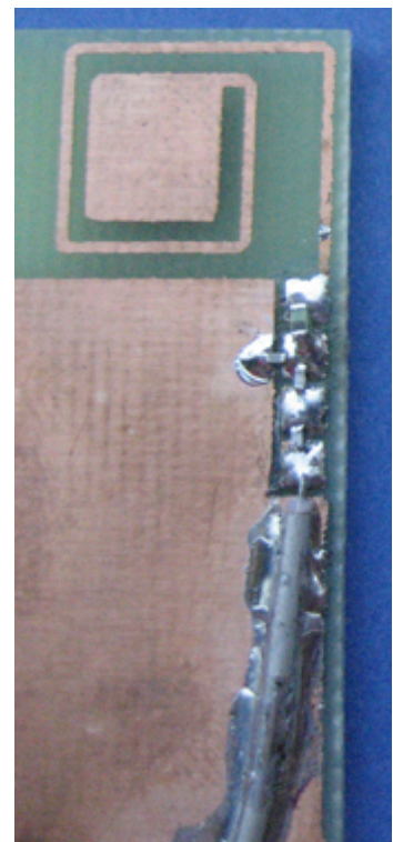
Figura 31. Detall d'una xarxa d'adaptació Detall d'una xarxa d'adaptació que utilitza components discrets de tipus SMD tant en sèrie com en paral·lel per a l'adaptació d'un monopoli miniatura.
