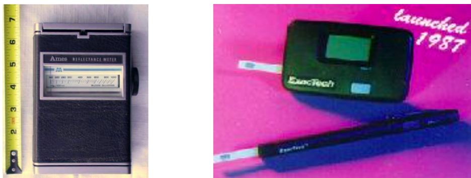
Figura 5 Izquierda: Primer lector electrónico de 1970. Derecha: Primer dispositivo de medida electroquímica [10]
