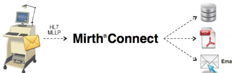
Figura 24. Esquema envío mensaje HL7 a BBDD, PDF y correo electrónico
