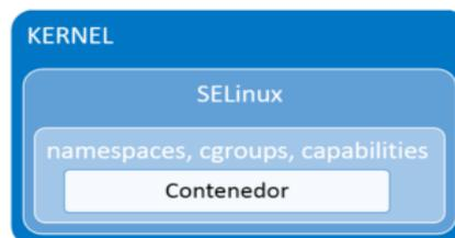
Ilustración 7: Vista de las capas que recubren un contenedor
