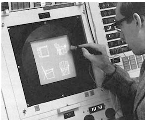
Fotografía desconocida. Esta imagen se reproduce acogiéndose al derecho de cita o reseña (art. 32 LPI), y está excluida de la licencia por defecto de estos materiales. Sketchpad; un software de dibujo de gráficos de ingeniería para el ordenador TX-2. Creado en 1963 por Ivan Sutherland como parte de su doctorado en el Massachusetts Institute of Technology, fue la primera interfaz gráfica de usuario para ordenadores.
