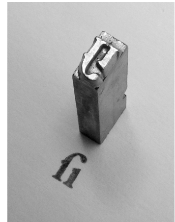
Tipo metálico tradicional para la ligadura fi, 2 pt Garamond. Nota legal: © Daniel Ullrich (2006). Creative Commons Reconocimiento Compartir Igual 3.0-es, publicada en Wikimedia Commons.
