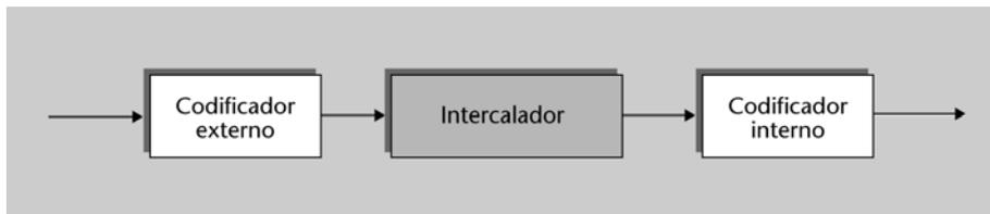
Figura 20. Uso de un intercalador en códigos concatenados.
