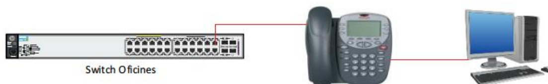
Il·lustració 15: Connexió PC a LAN mitjançant switch telèfon Avaya
