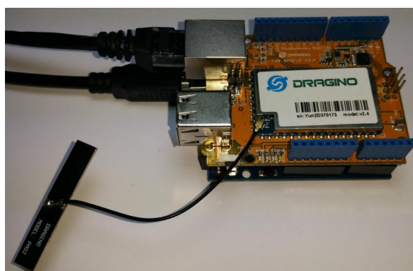
Ilustración 10: Montaje Servidor Broker MQTT
