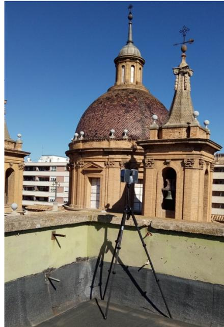
*Ilustración 17 Laser escáner 3D de Faro*
