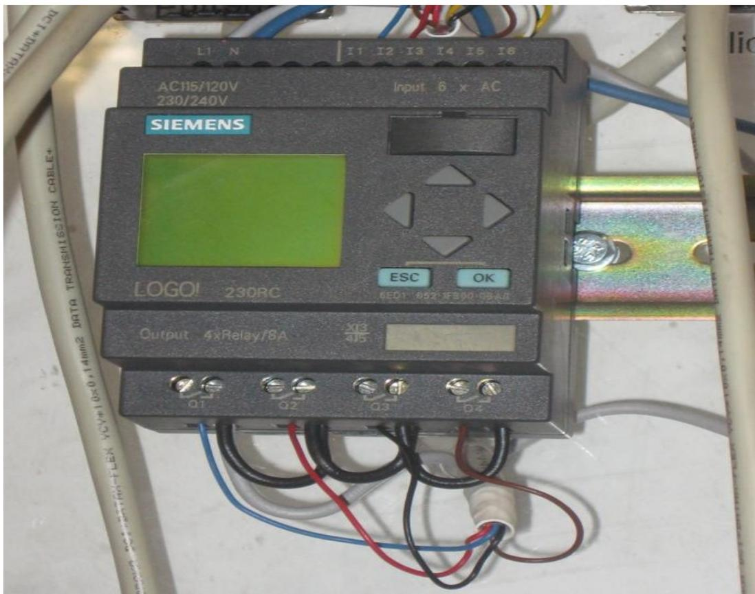
Figura 10: elemento de control de la marca SIEMENS modelo LOGO!.
