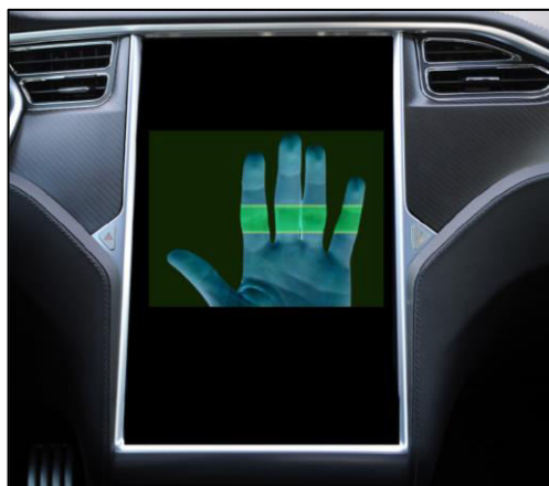
Figura 31: Sistema biométrico que escanea las venas de la mano e identifica al usuario
