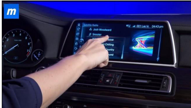
Figura 11: Consola central del coche BMW X6, con pantalla táctil a color de 10”
