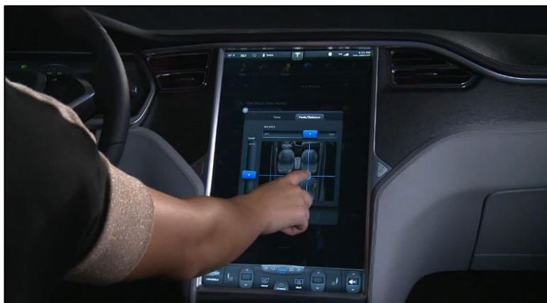
Figura 6: Consola central del coche Tesla Model S, con pantalla táctil a color de 17"
