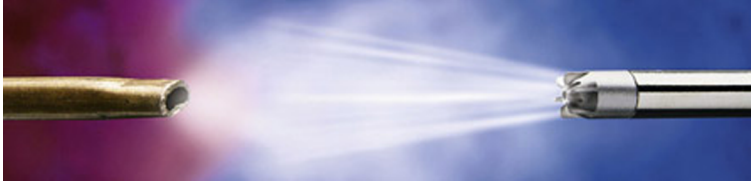
Figura 21. Dos broquets d'aire comprimit: comercial a la dreta i de bricolatge a l'esquerra
